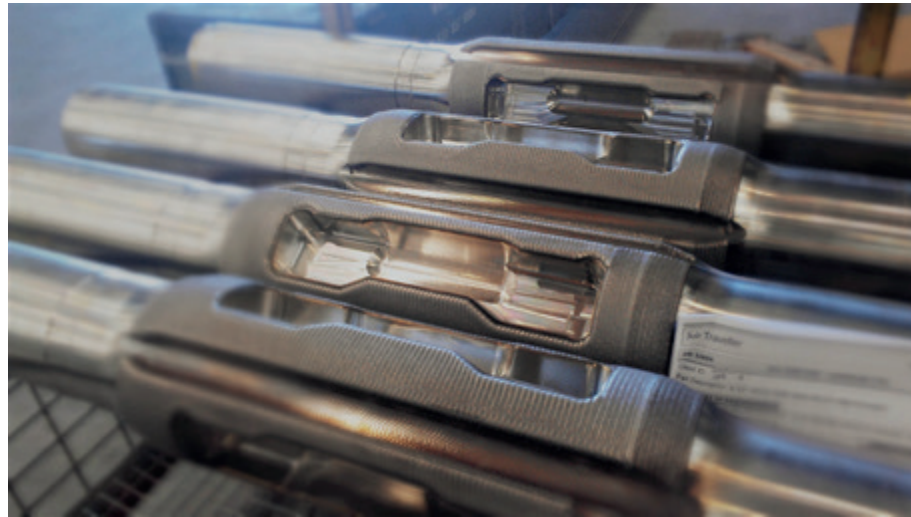
Bild 4: Laserauftraggeschweißte Stablatoren (Quelle: LaserBond Ltd.)
